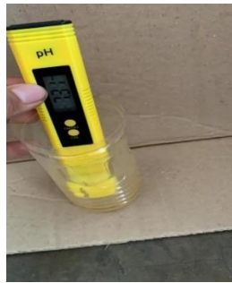
Rajah 3.3 Pengujian Nilai pH Dengan Menggunakan pH Meter
