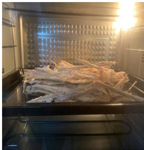
Rajah 3.2 Proses pengeringan hampas tebu menggunakan oven
